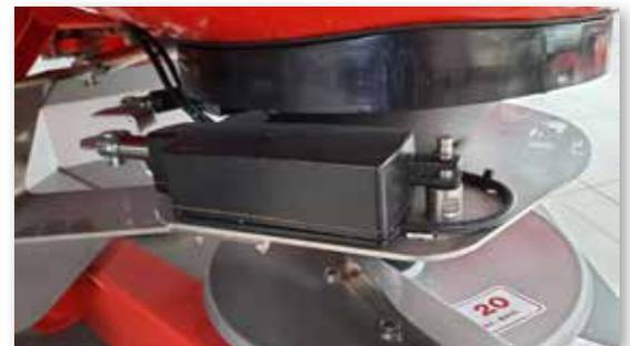
**Управление дозирующей заслонкой PRIMO E-EW (также ISOTRONIC)**
