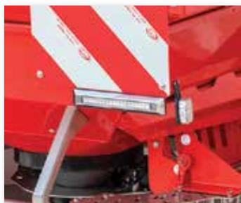
Комплект задних светодиодных фонарей (стандартное оснащение для PRIMO EW - E/EW-ISOTRONIC)
