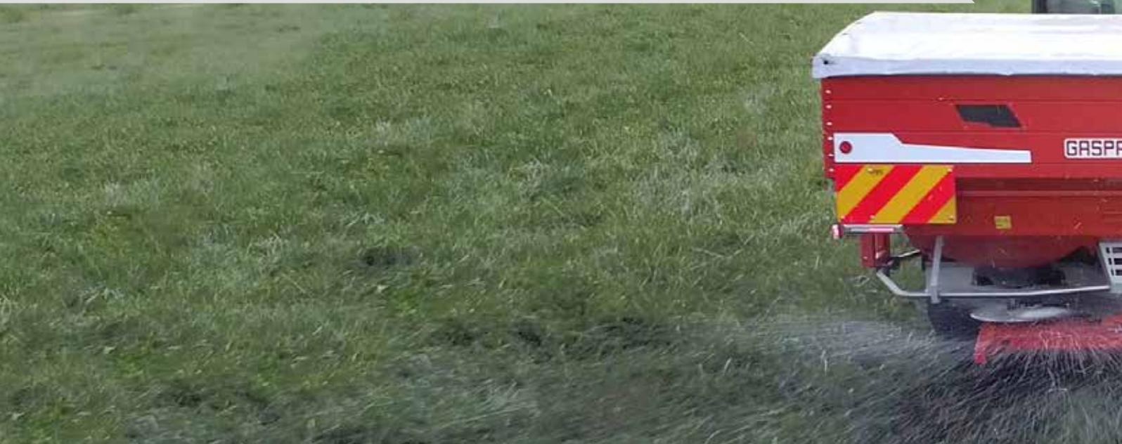
Разбрасыватель удобрений PRIMO имеет продуманную конструкцию: для изменения рабочей ширины не требуется регулировка лопастей диска или использование специальных инструментов.
